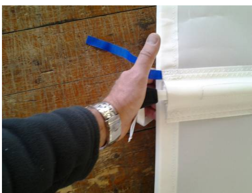
Poussez à fond pour mettre la latte en tension
