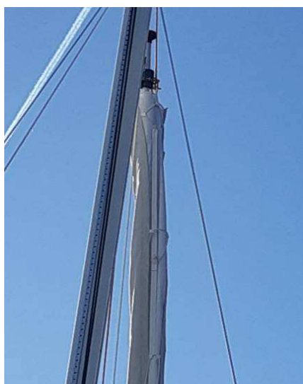
S'assurer que la housse est bien serrée en haut. Si ce n'est pas le cas, raccourcir les sandows supérieurs de la housse
