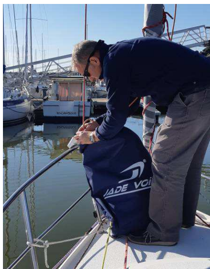
Accrocher le sac de stockage sur le balcon et sortir le haut de la housse
